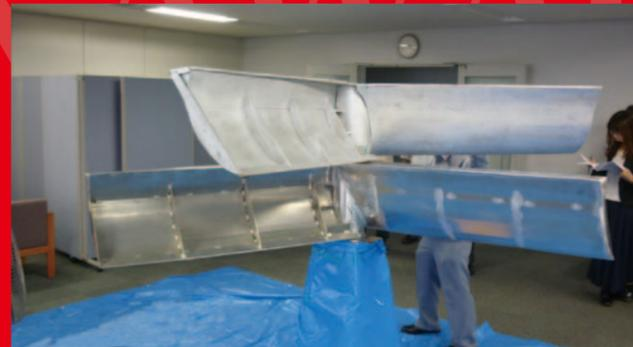
河川などに設置し、水流で回転して発電する水力発電用の水車です。
